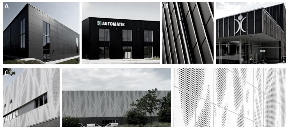
Fig. 8. Eksempler på detaljeringsgrad af facade. A: Simple løsning, stålplader med lodrette vinduespartier, der skaber variation i facaden B: Detaljeret facade, eksempel på detaljeringsgrad mod publikumsorienterede områder, her lodrette trælameller C: Detaljeret facader, perforerede plader kan nedbryde store monotone bygningsflader.
